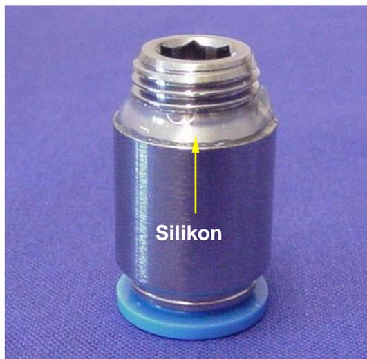
Abbildung 139: Steckverschluß mit Silikon
