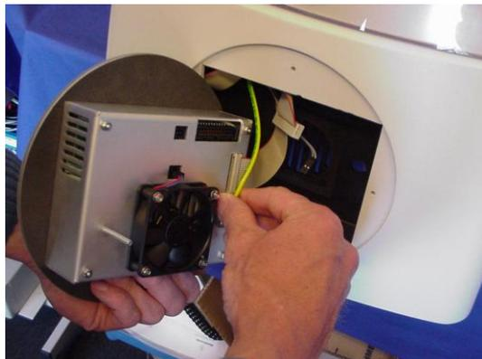
Abbildung 70: Steckverbinder abziehen
