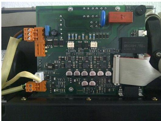
Abbildung 85: Leistungsmodul im Gerät
